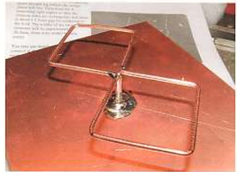
De straler. Verbonden met de messing buis/ mantel van de coax en de kern van de coax.
